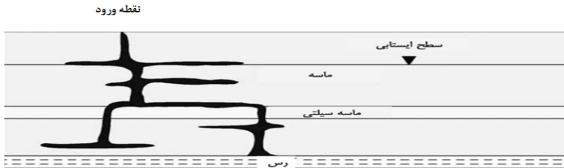
شکل ۱- نمایی از نحوه توزیع و رفتار مواد نفتی زیر سطح زمین
